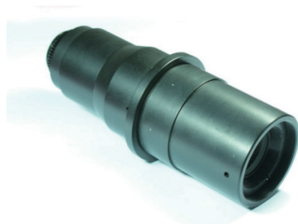
仿生双远心工业检测镜头（适用于芯片外观检测，工作距离180mm，放大倍率10x）
