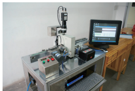
工业在线芯片外观缺陷检测仪（0.1mm精度，检测速度0.3s/pcs，成像分辨率1080p，帧频25fps）
